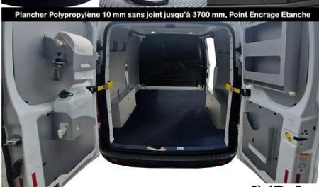
Plancher Polypropylène 10 mm sans joint jusqu'à 3700 mm, Point Encrage Etanche
