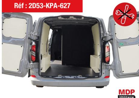
**Demontable sans outils Kit Bois avec Plancher Antidérapant Panneau de Particules L1 H1 2PLC MultiCab**
